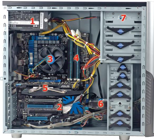
Рис. 4. Внутреннее устройство системного блока
