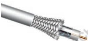
**Коаксиальный кабель** – вид кабеля, используемый в локальных сетях. Представляет собой два цилиндрических медных проводника, разделенных между собой изоляционным материалом или воздухом. Этот тип кабеля более устойчив к помехам, чем витой кабель. Скорость передачи данных – 50–100 Мбит/с. Длина связи достигает до нескольких километров.
