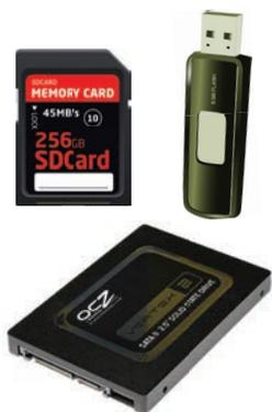
**Флеш-память** (англ. *flash memory*) – это особый вид полупроводниковой энергонезависимой перезаписываемой памяти. Флеш-память потребляет меньше энергии, чем магнитные и оптические диски. Флеш-память подключается к USB-порту компьютера, мобильного устройства, видео- или фотокамеры для чтения или записи информации. В настоящее время минимальный объем флеш-памяти составляет 1 Гб, а максимальный – 1 Тб. Но эти данные имеют тенденцию к увеличению.
