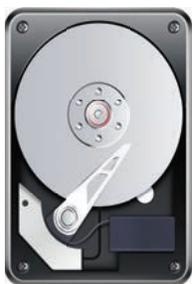
**Жесткий диск** – это большое по объему информационное хранилище компьютера (англ. **HDD** – *Hard Disk Drive*). Он представляет собой систему круглых алюминиевых пластин (плоттеров), между которыми располагаются считывающие головки. Пластины имеют магнитное покрытие, рабочие поверхности разбиваются на дорожки и секторы. В компьютере жесткий диск установлен в системном блоке. В настоящее время существуют съемные HDD-диски.
