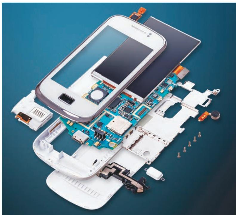
*Рис. 54. Основные составляющие мобильного устройства*
