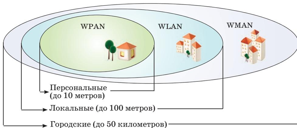
Рис. 22. Классификация беспроводных сетей по дальности действия
