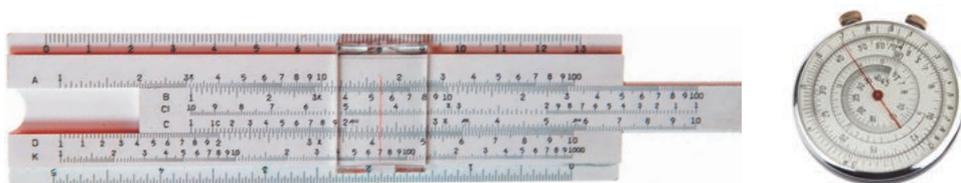
Рис. 5. Логарифмическая линейка
