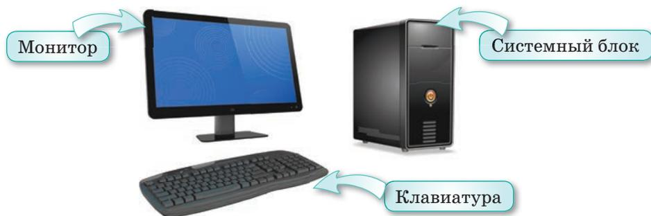
Рис. 8. Основные устройства компьютера
